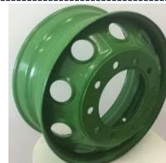
材料: 高强韧性热成形钢 轮辋: 3.3mm 轮辐: 9.0mm 重量: 23kg 热成形钢制超轻商用车车轮
