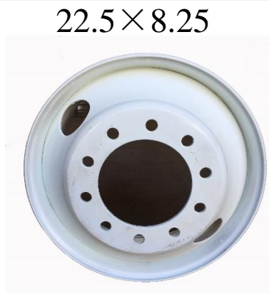
材料: SW400+RS590 轮辋: 4.5mm 轮辐: 11.0mm 重量: 31.4kg 第二代轻量化钢制商用车车轮
