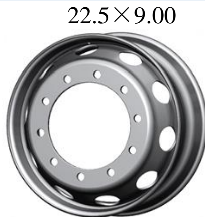
材料: SW460+590 轮辋: 5.3mm 轮辐: 14mm 重量: 37kg 第二代轻量化钢制商用车车轮
