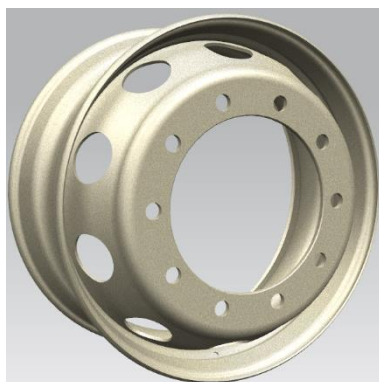
材料: 460+ 420 轮辋: 6.5mm 轮辐: 14.0mm 重量: 42kg 第一代轻量化钢制商用车车轮
