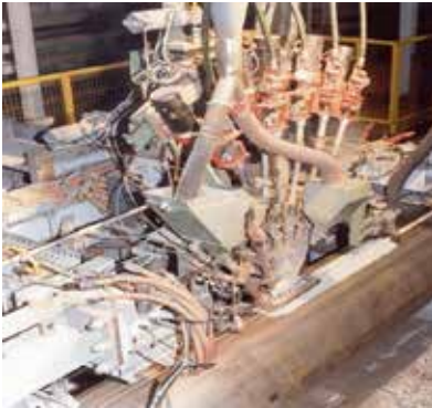
图13。埋弧焊 (图片来源于塔塔公司钢管)
