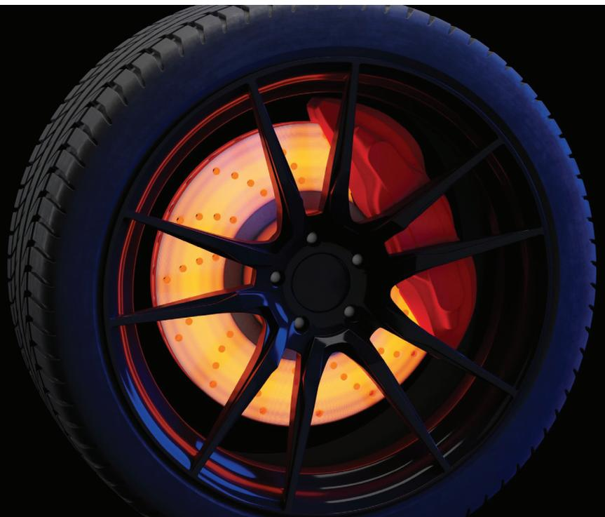
→ 将铌用于制造制动盘，以提高制动盘的热疲劳寿命。
