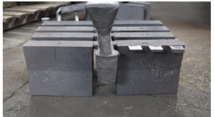
图 2 - 铸态 Y 型块试样
