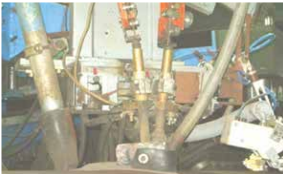
图3 b. 螺旋埋弧焊。(图片由Welspun提供)。
