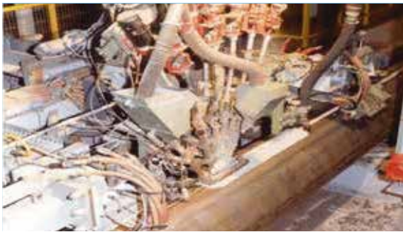
图3 a. 高强度低合金 (HSLA) 钢管直缝埋弧焊 (LSAW) (图片由塔塔钢铁公司提供)。
