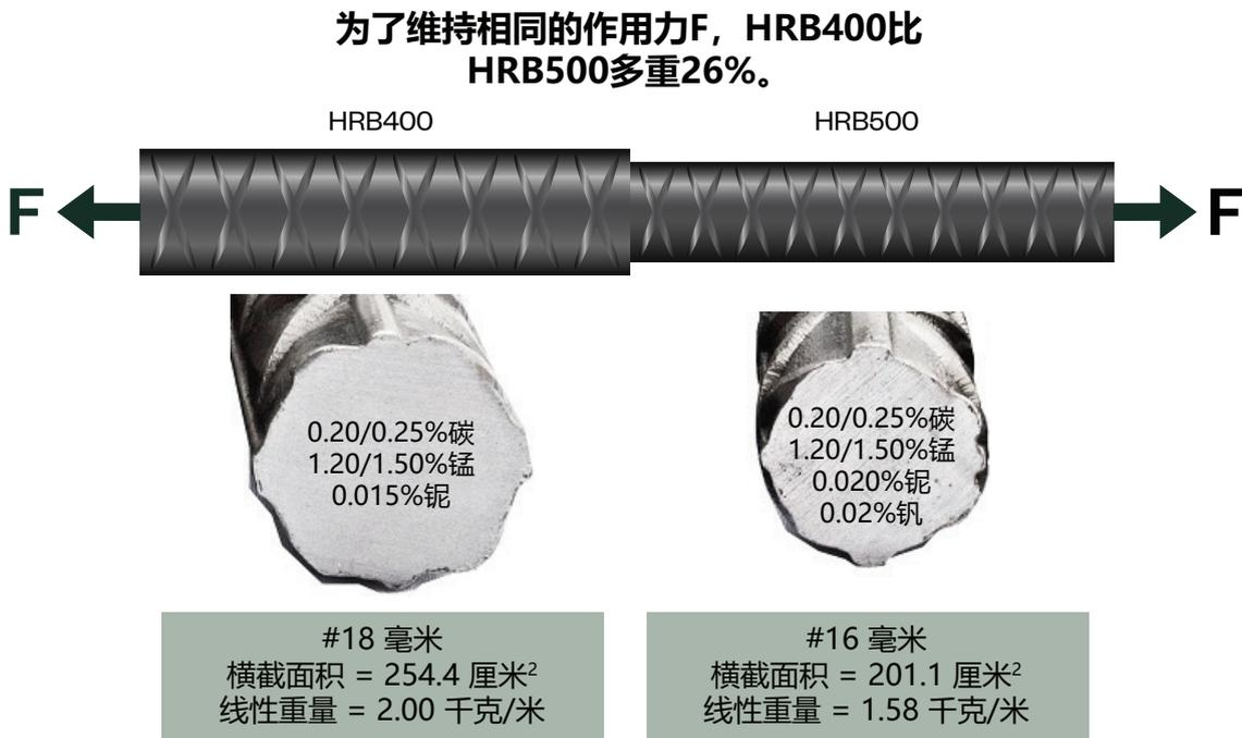
图2：当使用HRB500代替HRB400时，以及维持相同的作用力（F），钢筋截面减小的例子
